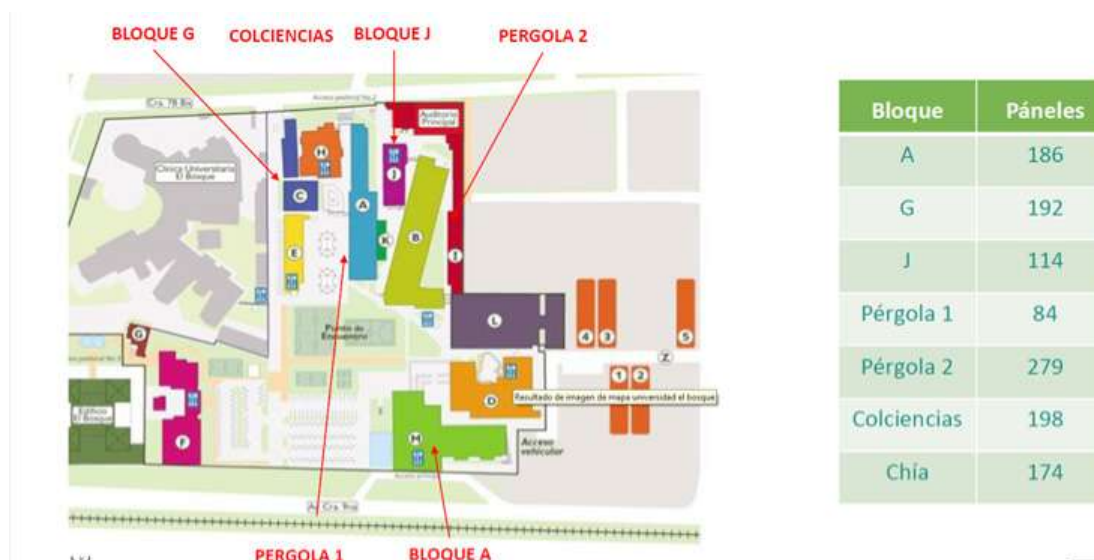
► Distribución paneles fotovoltaicos sede Usaquén.
